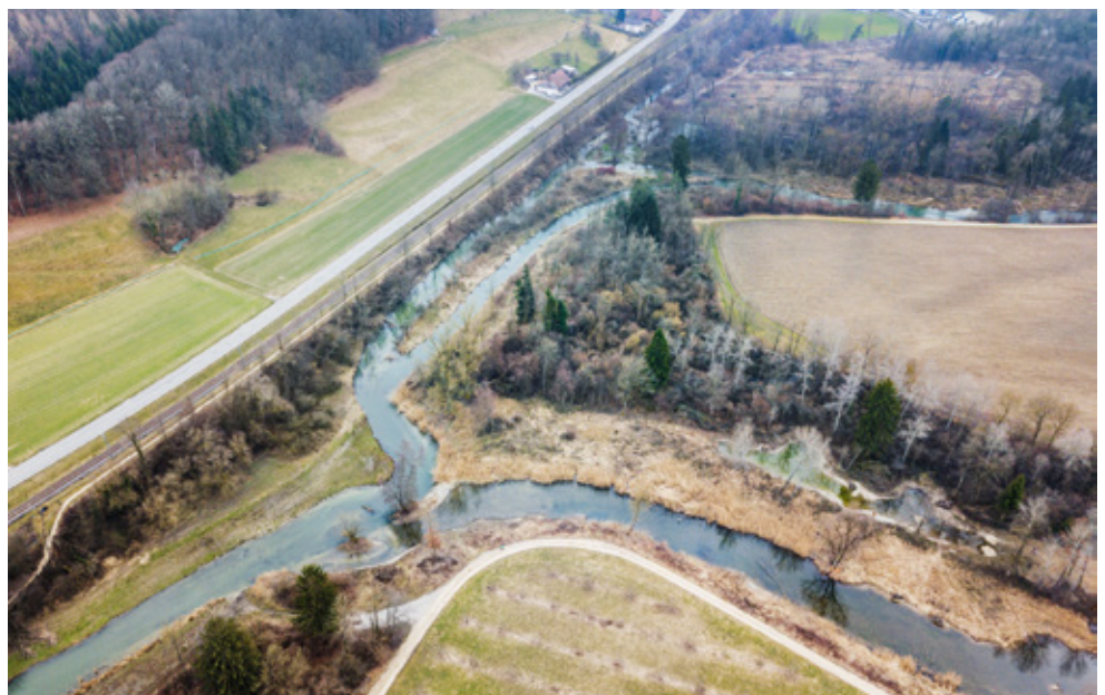
Das neu erstellte Seitengerinne fliesst unterhalb von Dotzigen zurück in die Alte Aare – bei Hochwasser entlastet es die oberhalb sichtbare Mündung des Eichibachs.
