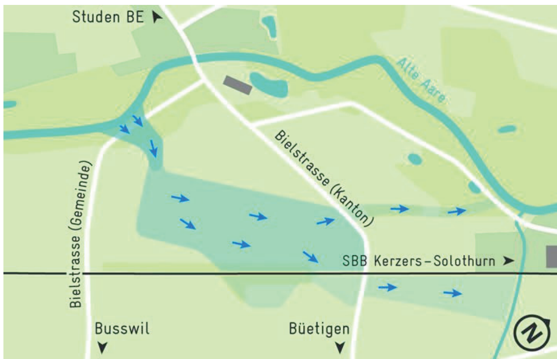
Fließende Retention Grossried-Nord: Eine landwirtschaftliche Fläche wird gezielt überschwemmt und das Wasser fliesst anschliessend langsam wieder ab.
